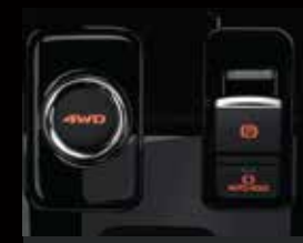
Phanh tay điện tử với chức năng giữ phanh tự động
