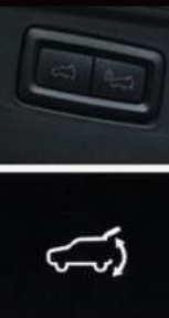
MỞ CỐP RẦNG TAY Cho phép người sử dụng mở hoặc đóng cửa bằng cách đưa chân vào khu vực hai cảm biến hai bên. CHỨC NĂNG KHÓA TỰ ĐỘNG Sau khi đóng cửa, xe sẽ tự động khóa lại. GHI NHỚ CHIỀU CAO MỜ CỐP Lưu lại chiều cao mở cửa theo ý muốn, giúp người dùng dễ dàng thao tác.
