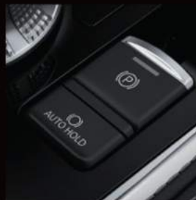
PHANH TAY ĐIỆN TỬ TỰ ĐỘNG Khi chuyển cần số về vị trí "P", hệ thống sẽ tự động kéo phanh và hệ thống sẽ nhả phanh khi cần số chuyển sang các số khác. Hệ thống cũng tự động kéo phanh khi nhận thấy xe dừng hơn 10 phút nếu chế độ "Giữ phanh tự động" được bật.
